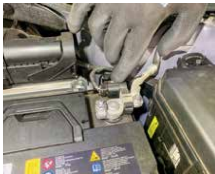
Sensor IBS fixado diretamente sobre o terminal negativo da bateria
