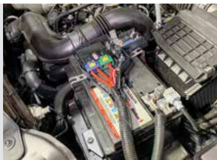
Bateria com terminal positivo com diversas conexões.
