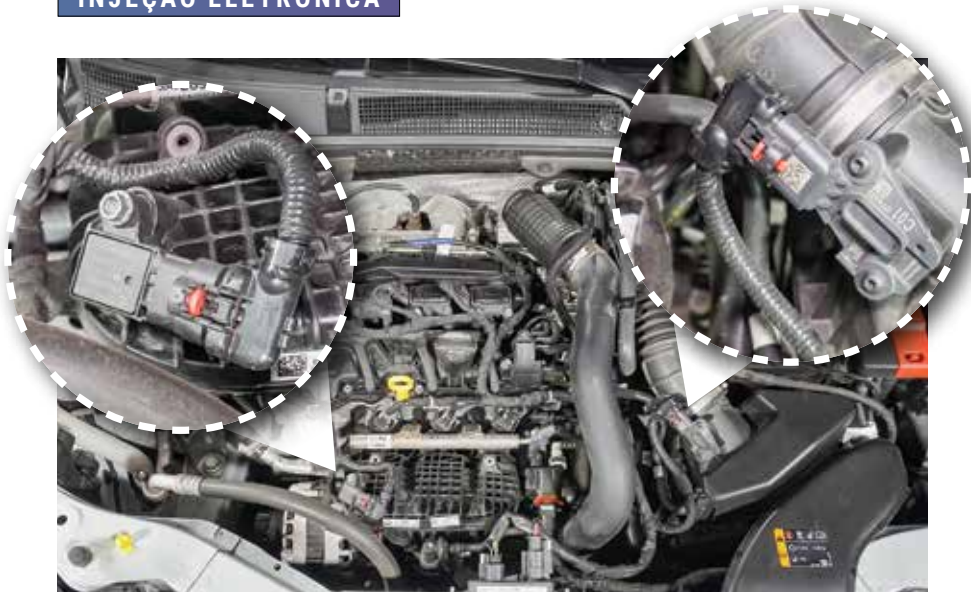
Sistema de injeção eletrônica do motor 1.0 turbo do Chevrolet Onix 2025 possui tanto o sensor MAP (esq.) no coletor de admissão quanto o MAF (dir.) na tubulação próxima à caixa do filtro de ar.
