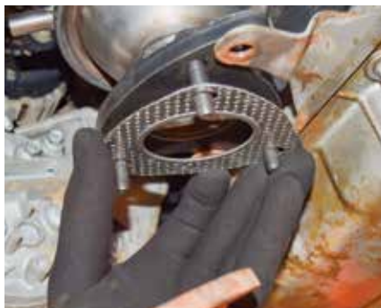
Sempre troque as juntas de vedação do catalisador e do coletor na troca do conversor catalítico: isso evita a entrada falsa de ar e o efeito “maçarico” sobre a cerâmica
