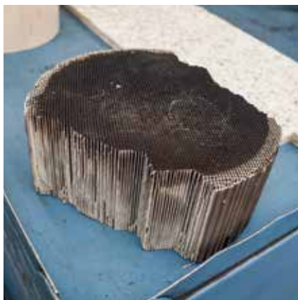
Problemas de ignição causam o derretimento do catalisador e, até mesmo, sua quebra
