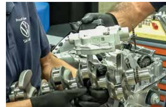
Engrenagem no eixo do virabrequim que faz o acionamento da engrenagem da bomba de óleo por meio de corrente
