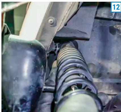
**12)** Solte a porca superior do amortecedor e remova o componente.
