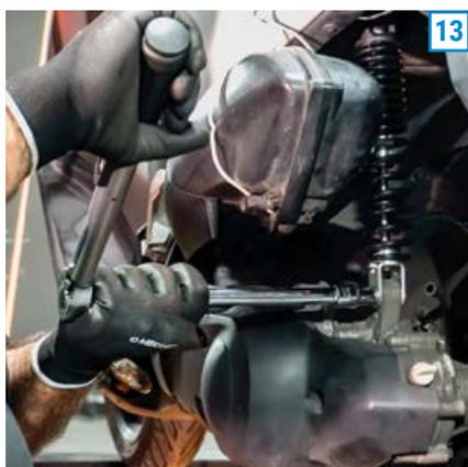
**13)** Desça a scooter do cavalete e realize um teste subindo e descendo a traseira da moto para verificar o funcionamento dos novos amortecedores.
