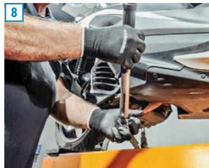
**8)** Monte o escapamento, apertando as duas porcas sextavadas de 12 mm de conexão do escapamento e os três parafusos sextavados de 14 mm de suporte do escapamento.
