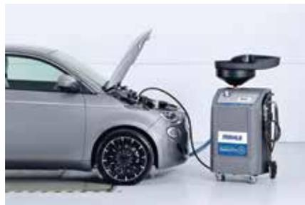
O equipamento permite esvaziar e reabastecer o sistema de forma totalmente automatizada, sendo útil em situações como reparos em baterias de alta tensão ou substituições de componentes do circuito de resfriamento. Além disso, a ferramenta realiza testes de pressão e vácuo para verificar eventuais vazamentos.
