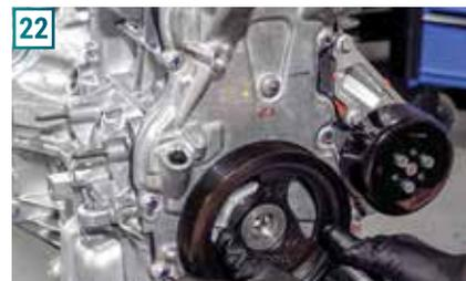
**21)** Instale a polia da bomba d'água, aplicando o torque de 30 Nm.
