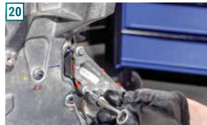
**20)** Instale a bomba d'água, aplicando o torque de 25 Nm.
