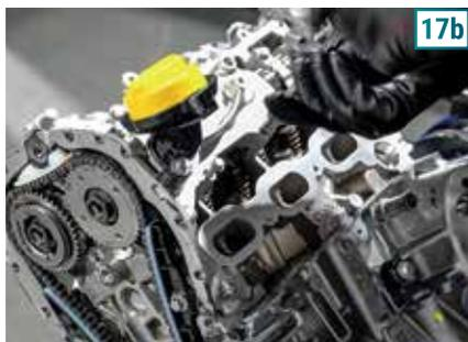
**18)** Instale a tampa da face de distribuição do motor, seguindo a sequência da imagem ao lado. O torque 55 Nm nos parafusos de 13 mm, o torque de 25 Nm nos parafusos de 10 mm e torque de 10 Nm nos parafusos de 8 mm.
