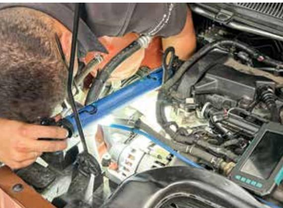
Durante o período em que acompanhamos o diagnóstico do veículo, não havia luz acessa no painel, então foram realizados testes com base no código de falha apresentado via scanner e, outros testes para validar se o que havia sido informado ao cliente pela loja. De fato, a falha de motor estava ocorrendo e foi constatado que o problema é mecânico com má vedação da válvula de escapamento do primeiro cilindro.
