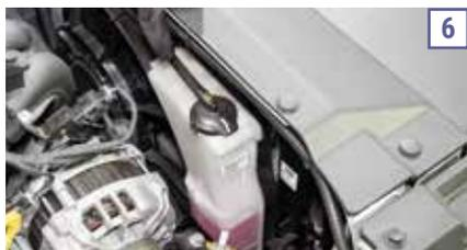
Em relação ao sistema de arrefecimento, o vaso de expansão (6), embora esteja um pouco “escondido” no cofre do motor, é prático de manter, de acordo com China. Sobre o lubrificante (7), China destaca que a marca recomenda o 5W30, mas ele prefere utilizar o 0W30 quando o cliente permite. “Eu opto sempre pelo 0W30, pois acredito que ele melhora o desempenho
