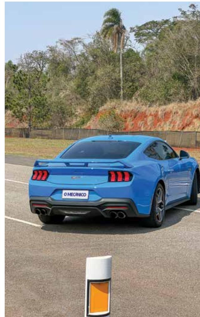
Caso for retirado o pé do acelerador e acionado o pedal do freio ao se aproximar do veículo a frente, o sistema não realiza a atuação de frenagem autônoma, pois entende que o condutor tem reação de parar o veículo sem que haja atuação do sistema de segurança.
