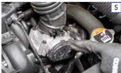
sário desmontar as duas caixas para ter acesso a elas. Por sua vez, o sistema de injeção dispensa o tanquinho e o bico injetor tem dois circuitos elétricos: um para aquecimento do combustível e outro para acionamento do bico injetor. Segundo China, a manutenção desses componentes, assim como do corpo de borboletas (5), não é difícil.
