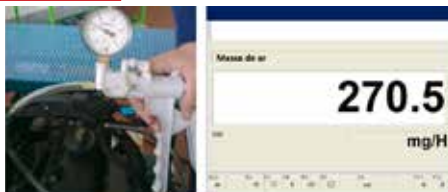
Pressão de teste pneumático aprox. 0,4bar; Válvula EGR ligada (em marcha lenta)
