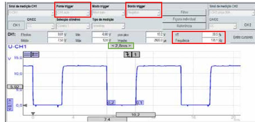
Sinal Elétrico do Sensor de Etanol
