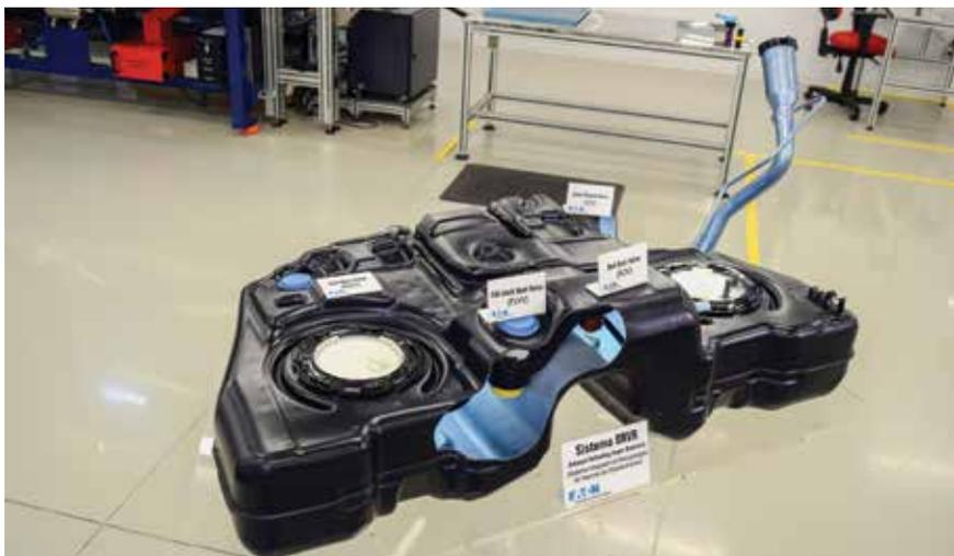
Com foco no futuro, a edição 349 da **Revista O Mecânico** desmistificou o sistema ORVR, que é um sistema composto por um conjunto de filtros para controlar os gases provenientes do tanque durante o abastecimento de combustível e, também, em longos períodos de estacionamento diurno. Esse sistema, que será obrigatório
