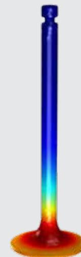
normais de funcionamento que vão desde os 100°C até os 550°C dependendo da região específica da válvula.
