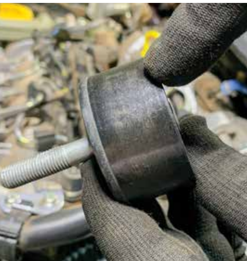
Sinal de derretimento com o rolamento de apoio, provocado pelo atrito do dorso da correia de sincronismo
