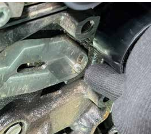
Pino no bloco do motor que deve ser montado entre as abas do tensionador
