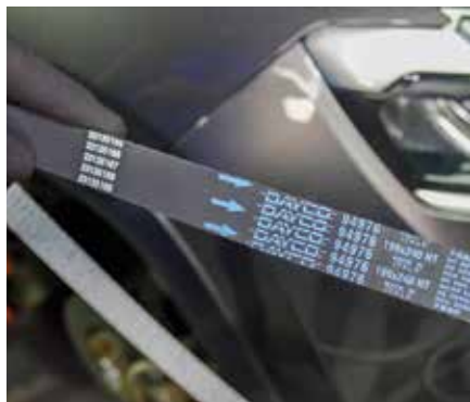
Sentido rotacional da correia e indicações para instalação nas polias dentadas do comando de válvulas e bomba de alta pressão
