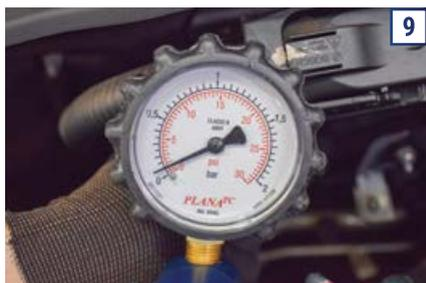
6) Aplique um pouco de pressão no sensor com a bomba de pressão manual, e verifique se a pressão manométrica indicada (6a) é a mesma apresentada no scanner (6b). Se os valores estiverem correspondentes, isso significa que o sensor está calibrado.
