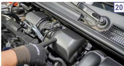
O filtro de ar do motor (20) possui acesso fácil ao mecânico e o sensor MAF tem sua localização próxima (21). A caixa de ressonância do Civic é facilmente encontrada (22). A recomendação da troca do filtro de ar do motor é de 30 mil km ou 36 meses. Para o filtro de cabine, a troca deve ocorrer a cada
