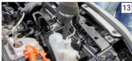
do ao motor a combustão (13). “A Honda melhorou bastante a acessibilidade, a verificação de nível, e o processo de retirada do reservatório para realizar uma limpeza ou uma troca de fluido”, explica Camilo.
