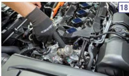
Para ter acesso a bomba de alta pressão (18) é necessário a retirada da capa do motor que funciona como manta acústica para reduzir o som emitido pelas vibrações.
