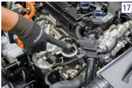
Outro componente de fácil acesso é a válvula de EGR (17) e possui uma particularidade de resfriamento, Matheus comentou sobre. “Logo na frente é possível visualizar duas tubulações que saem do cavalete onde está a válvula termostática. Os gases que serão circulados novamente têm sua temperatura diminuída, assim há um melhor aproveitamento no momento da queima dos gases”.
