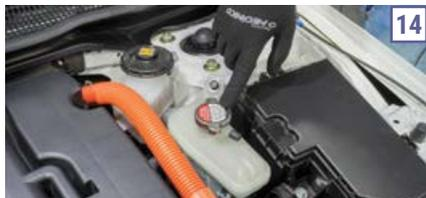
A pressão do sistema é variada conforme o controle da tampa que possui uma válvula, localizada no radiador do veículo, comum entre os veículos da marca.
