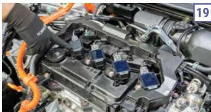
Na parte de injeção, as bobinas são facilmente encontradas com a retirada da capa do motor (19). As velas de ignição são de irídio e tem prazo de substituição a cada 100 mil km. A Honda recomenda a utilização regular do Engine Cleaner Pro Honda, a fim de prevenir qualquer tipo de formação de depósitos na câmara de combustão e no sistema de injeção de combustível.
