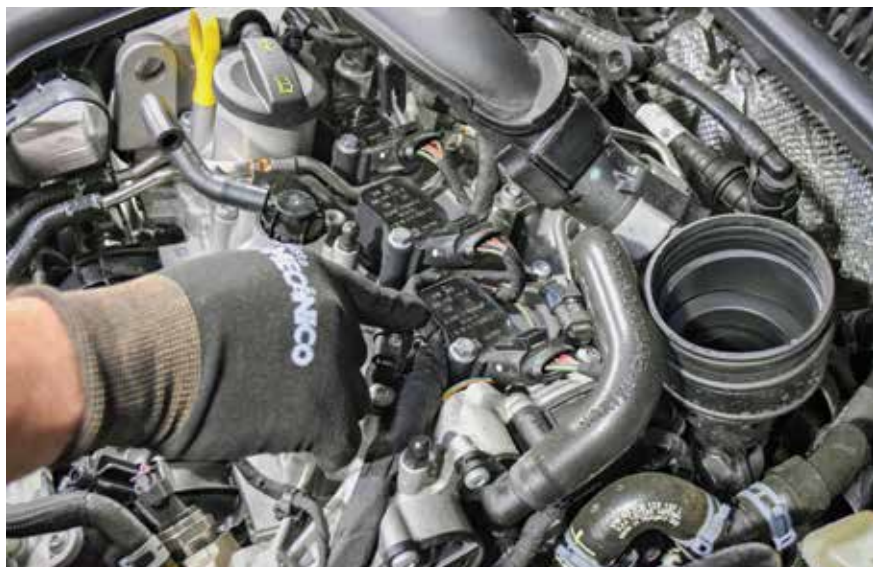
Bobinas individuais no VW Nivus TSI
