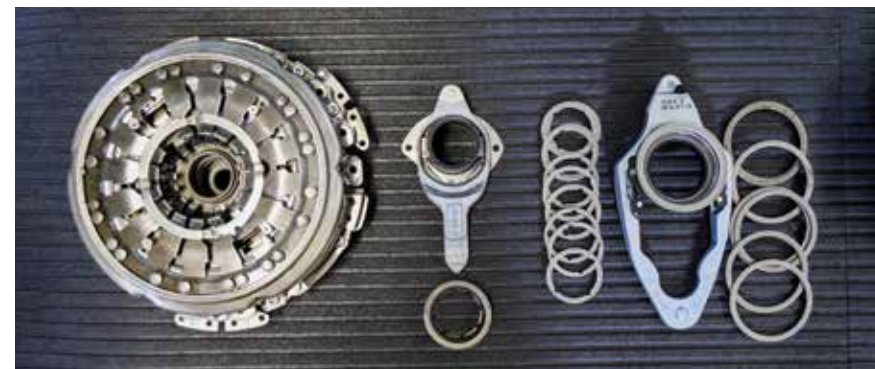
Sistema de acionamento das marchas – DQ200 de primeira geração
