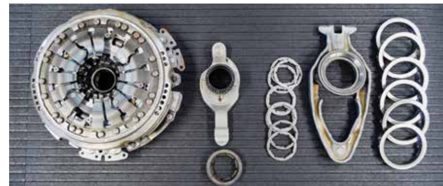
Sistema de acionamento das marchas – DQ200 de segunda geração
