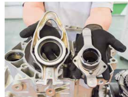
DQ200: garfos de acionamento são a principal diferença entre as duas gerações
