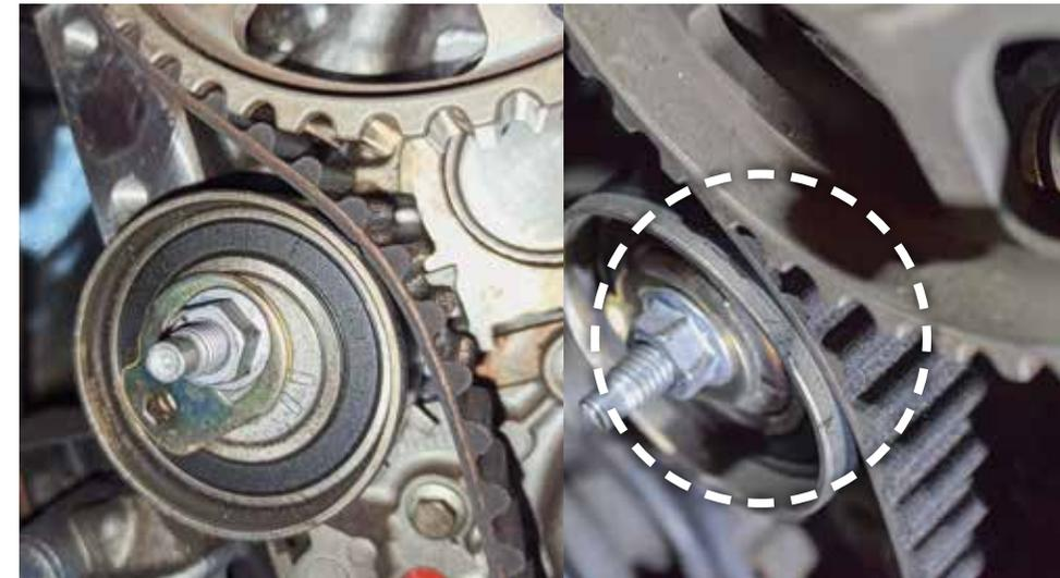
*Falta de tensão fez a correia trabalhar solta (à esq.), causando desgaste prematuro nos componentes e superaquecimento na pista do tensionador, causando perda da lubrificação (à dir.)*
