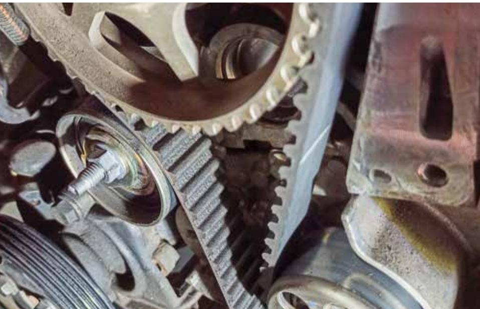
da Dayco, o coordenador técnico Davi Cruz e o assistente técnico Romário Teixeira analisaram o caso e atestaram que a causa foi a instalação incorreta do tensionador: ele estava trabalhando totalmente solto, sem aplicar tensão alguma sobre a correia. Tudo indica que, na instalação, o profissional apenas retirou o pino-trava, como se este fosse um tensionador automático, e não movimentou o componente para a posição correta de trabalho.
