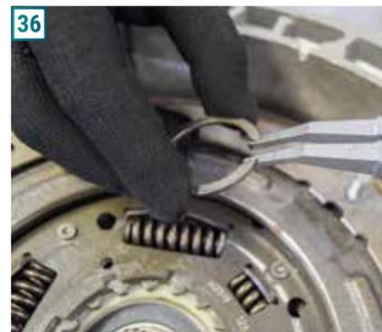
**36)** Com alicate apropriado, instale o anel elástico que trava o eixo secundário.
