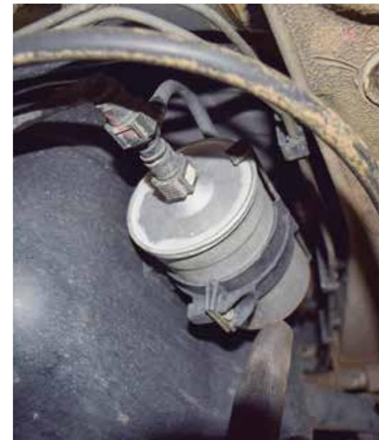
Com relação ao elemento filtrante, Bosch (2005) afirma que são formados por fibras finíssimas de celulose e poliéster, dobradas em estrela. No entanto, cresce a tendência de utilização de fibras totalmente sintéticas.
