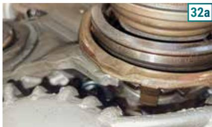
**32)** Siga para o conjunto dos rolamentos de acionamento. A instalação é manual, mas o mecânico precisa verificar o ponto de encaixe girando a peça até que ela fique alinhada com os garfos ímpar (32a) e par (32b). Em seguida, posicione as duas chapas de contato (32c).
