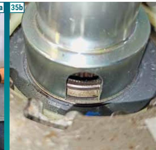
**35)** Novamente com a chave de força ou catraca com soquete 22 mm, gire o fuso do extrator no sentido horário para descer o conjunto de dupla embreagem até o limite da bucha de assentamento (35a). Essa bucha possui uma guia como limitador (“stop”) para o eixo secundário (oco) e dois rasgos para visualizar o canal de alojamento do anel elástico que trava o eixo secundário quando a embreagem atinge o ponto desejado (35b). Ao final, desmonte novamente todas as ferramentas.
