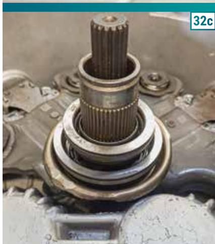
**34)** Para assentar o conjunto de dupla embreagem em sua posição de trabalho, será instalado novamente o extrator, que desta vez será utilizado para empurrar o conjunto. Para essa função, é necessário utilizar uma bucha de assentamento (maleta LuK 400 0427 10) (34a). O extrator deve ser apoiado com três elementos de apoio parafusados diretamente na carcaça do câmbio (todos da maleta LuK 400 0418 10) (34b).
