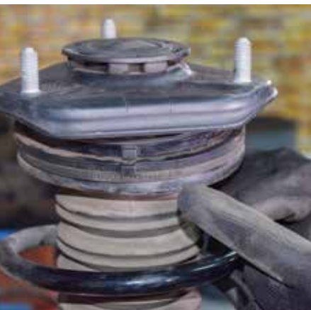
Coxim dianteiro possui marcações que indicam a posição correta de montagem
