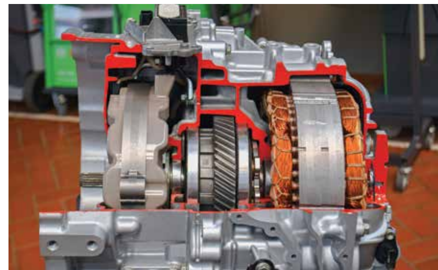
Conjunto de transmissão do Toyota Prius III em corte
