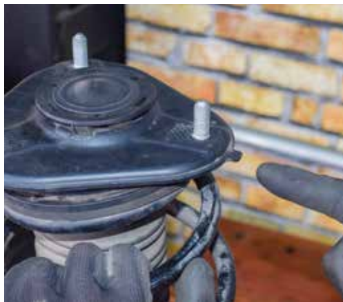
Coxim dianteiro possui marcações que indicam a posição correta de montagem
