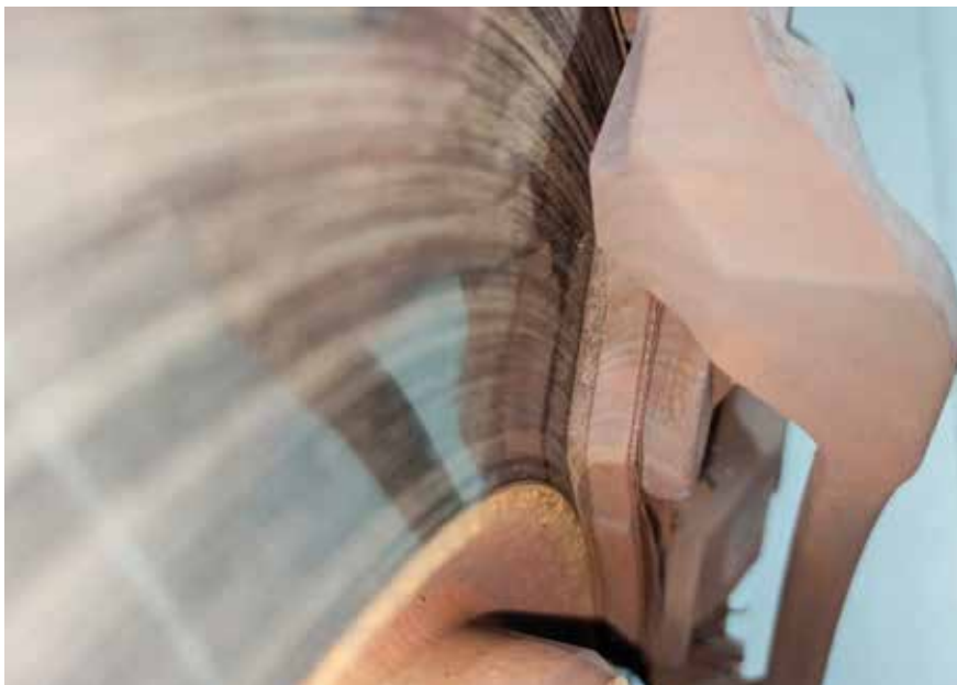
Materiais de atrito dianteiros estavam no limite máximo de desgaste
