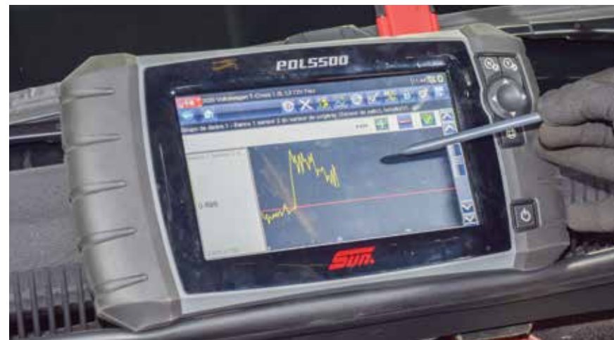
Sinal da sonda lambda pré-catalisador no VW T-Cross 200 TSI não é senoidal
