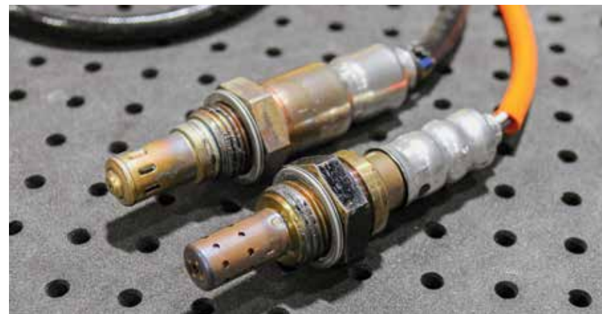
Sondas lambda de banda larga (chicote preto) e convencional (chicote laranja)
