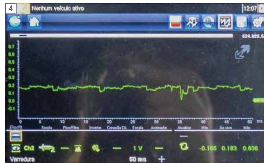
Sinal da sonda pré-catalisador, via osciloscópio
