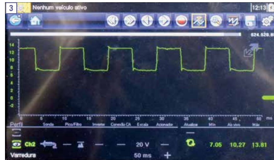
Sinal do aquecedor, sonda pré-catalisador, via osciloscópio
