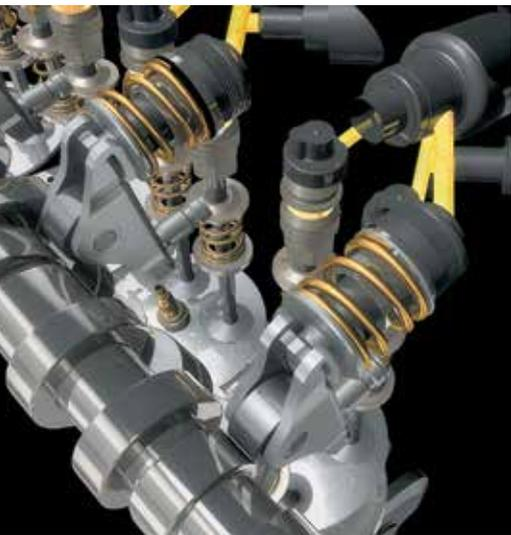
força para jogar o ar de um lado para o outro. Isso faz com que a eficiência do motor aumente. No caso do MultiAir, a diferença é de mais de 10% de eficiência em cargas baixas em relação ao motor sem a tecnologia”, garante o engenheiro.
