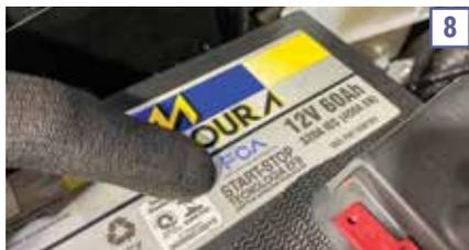
Apesar de não haver start-stop de série no Pulse, a bateria de 60 Ah é do tipo EFB (8), preparada para o uso desse sistema. “É uma bateria bem mais cara que uma convencional. Na hora da substituição, é necessário utilizar o mesmo padrão original de fábrica para não sobrecarregar alternador e outros sistemas elétricos”, recomenda.
