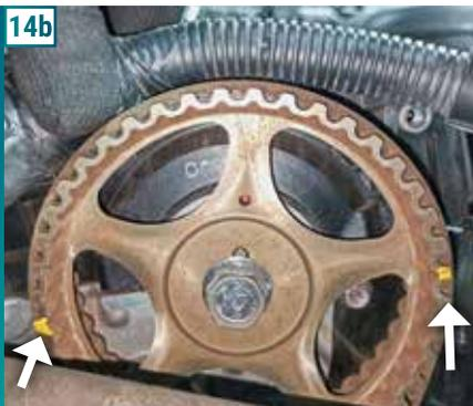
**14)** Observe que o sincronismo da polia do comando de válvulas é dado por um pequeno furo na polia que deve estar alinhado com uma marca vermelha atrás dele, no cabeçote. E ao mesmo tempo, existem duas marcações na polia (14a) que ficam alinhadas com o topo do cabeçote (14b). Ao notar que todas as referências estão alinhadas, utilize uma ferramenta apropriada para travar o motor no ponto.
