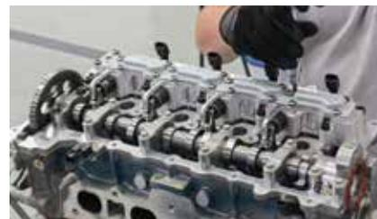
**28** Sistema **MultiAir** substitui o variador de fase em motores Fiat e Jeep
