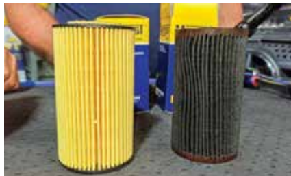
Filtro de óleo novo ao lado do usado
