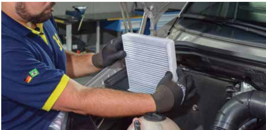
Filtro de cabine Blue.care sendo instalado na Sprinter: lado em azul fica voltado para a tubulação, seguindo o fluxo de ar
