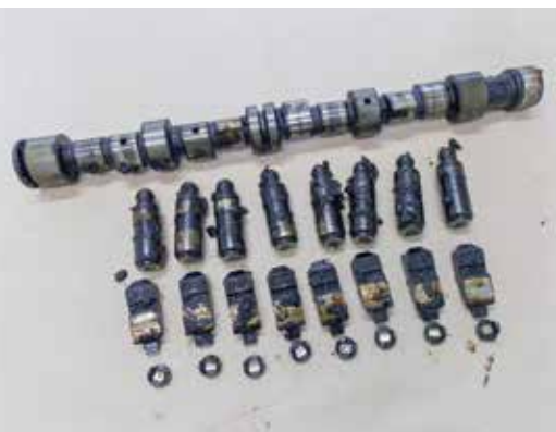
Borra em tuchos hidráulicos, balancins, roletes e comando: consequência da falta de manutenção preventiva
