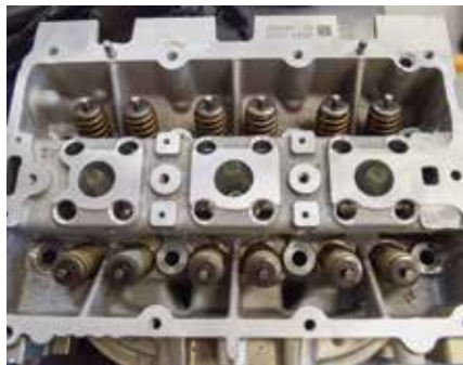
Válvulas no cabeçote do motor 1.0 EA211
