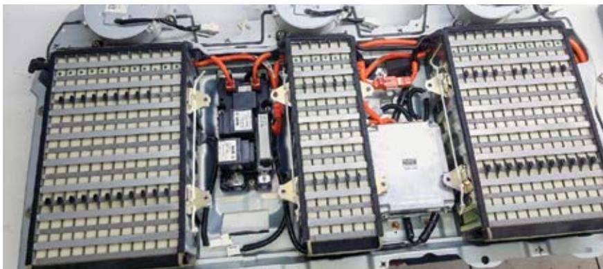
Pack de baterias: não mexa sem treinamento ou ferramental específico
