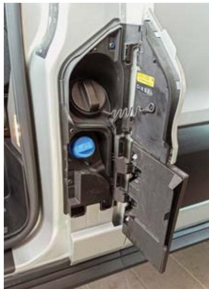
Bocais dos tanques de diesel e Arla ficam ao lado da porta do motorista
