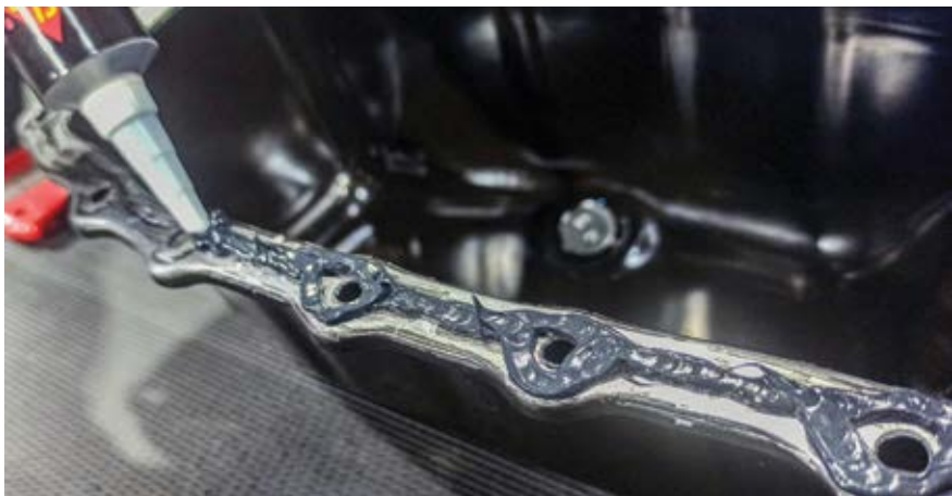
Silicones oxímicos podem ser aplicados em cárter de motor
