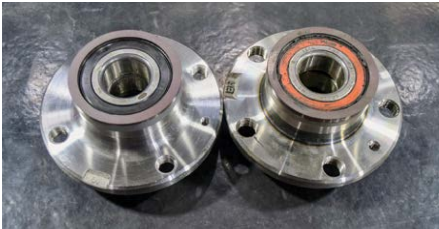
Rolamentos 801191 lado a lado: quatro furos com ABS de reposição (à esq.) e o de cinco furos com ABS original, removido da SpaceFox
