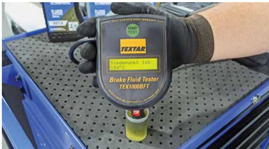
Qualidade do fluido é comprovada através do teste do ponto de ebulição
