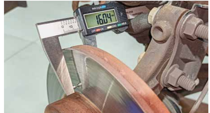
Medição de disco com paquímetro específico para a função, com pontas secas nos apalpadores
