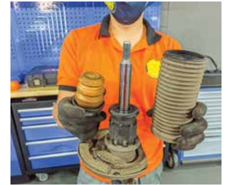
Haste recolhida em repouso: os amortecedores estavam sem ação alguma
