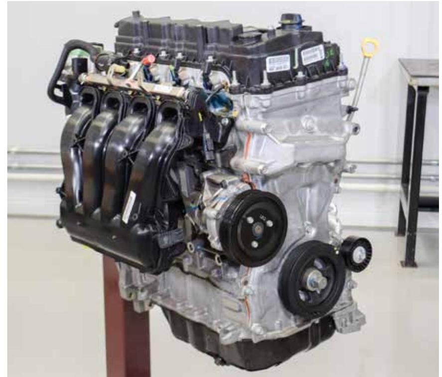
combustão. O curso total de levantamento das válvulas de admissão (conhecido como Full Lift), sistema convencional de abertura nos motores de Ciclo Otto, é utilizado pelo MultiAir somente quando é necessária potência máxima do motor.
