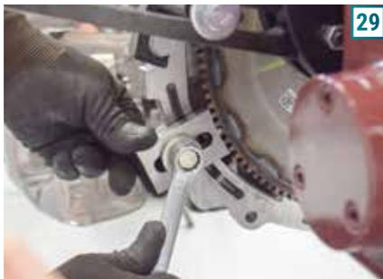
**29)** Para a remoção da polia dos órgãos auxiliares do motor, faça o travamento do flex plate pela engrenagem do motor de partida.
