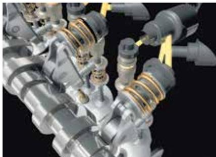
pinos flutuantes e revestimento especial (chamado de “Diamond-Like Carbon” ou simplesmente DLC), a fim de reduzir o atrito interno. O virabrequim é de aço forjado para aumentar a resistência do conjunto, enquanto as velas têm a ponta dos eletrodos de irídio.
