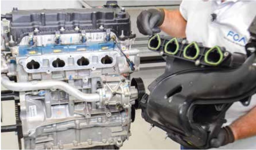
A atuação do MultiAir garante o controle dinâmico da entrada de ar, cilindro por cilindro, e ciclo por ciclo. O funcionamento é feito com o auxílio de um pistão, movido por um came mecânico, conectado à válvula de admissão por meio de uma câmara hidráulica controlada por uma válvula solenóide que é ligada a uma unidade eletrônica de controle. Desta forma, o curso de levantamento da válvula varia conforme a demanda de ar do motor.
