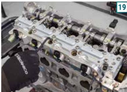
**19** REMOÇÃO E CUIDADOS DE INSTALAÇÃO DO MÓDULO DO MULTIAIR
