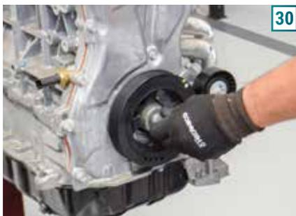
**31)** Utilize chave 13 mm para a remoção do rolamento de apoio. Na montagem, é necessária a aplicação de trava química no parafuso do tensor e torque de aperto de 25 Nm.
