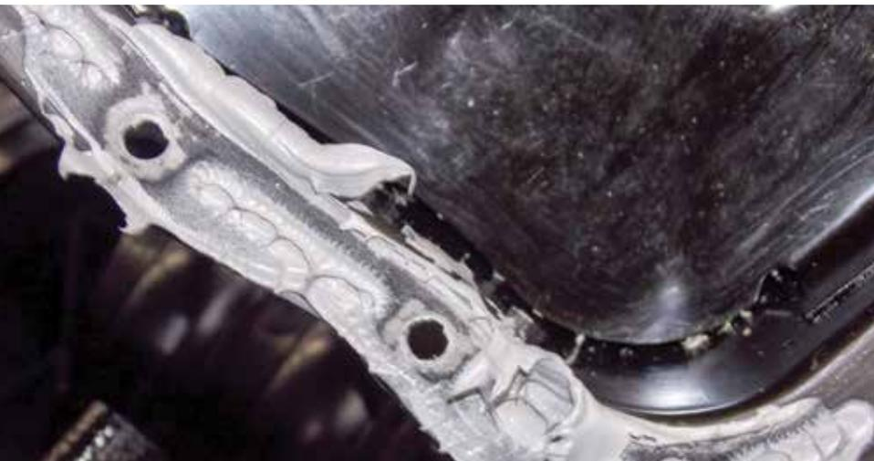
*Selante (ou junta líquida) aplicado em excesso pode provocar escorrimento para dentro do motor ou câmbio, entupindo galerias de lubrificação*
