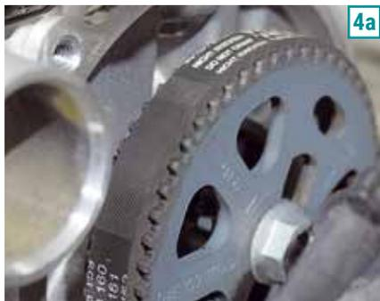
5) Ao lado da polia da correia da bomba d'água, fica a tampa de acesso à faseagem do comando de admissão, presa por um parafuso de cabeça hexalobular T30. Para ajudar a sacar a tampa, use com cuidado uma chave de fenda. A tampa possui vedação por o'ring, que pode ressecar. Troque o anel a cada remoção.
