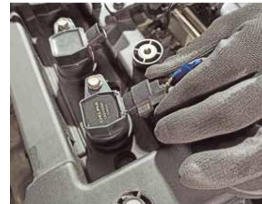
Conector de bobina do HB20 pode ser fonte de mau funcionamento por quebra da trava
