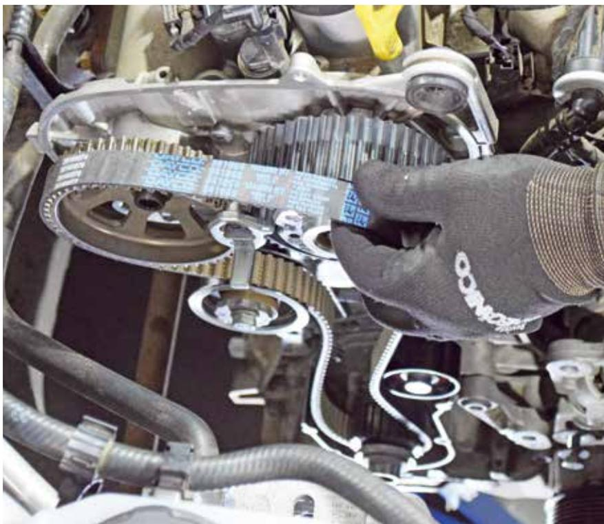
**20 Motor:** Sincronismo da família dos motores Volkswagen EA211 causa dúvidas no mercado; veja como fazer a substituição da correia dentada no modelo Polo 1.0 MPI
