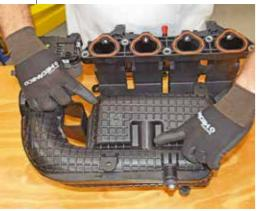
Esse atuador é ligado a uma eletroválvula e movimentado por um sistema de vácuo, que capta a depressão no próprio coletor e a armazena em um tanque, regulado por uma válvula idêntica a de um servofreio. O atuador se comunica com esse tanque através de uma tubulação e, quando recebe o comando elétrico da ECU da injeção, abre ou fecha a borboleta interna que direciona o ar admitido para o circuito desejado naquele regime de motor.
