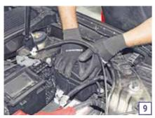
Ainda é necessário remover todo o coletor de admissão para obter acesso à remoção das velas (vida útil de 40 mil km), bobinas e bicos injetores (6). Mesmo assim, para executar a operação, basta desligar o chicote elétrico, as mangueiras e soltar os parafusos com uma chave L 10 mm. Já a mangueira de alimentação de combustível tem acesso fácil e é ligada à flauta por engate rápido.
