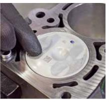
a combustão fica lenta por causa da presença de gás de descarga na combustão. "Por isso, é necessário promover a aceleração da combustão, e isso é feito basicamente pelo sistema de ignição de alta energia e pelo sistema de combustão de alta turbulência", aponta. A turbulência é gerada pelo formato dos condutos, válvulas e câmara de combustão, o que traz a necessidade de se observar mais detalhes durante a manutenção.
