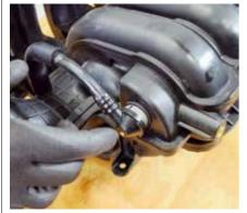
Válvula semelhante à do servo-freio é responsável por acionar o atuador do VIS
