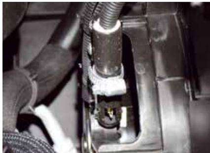
Removidas as proteções, é possível ter melhor acesso aos componentes para manutenção. O primeiro aspecto notado pelo mecânico é o tipo de fixação das peças. “A resistência da velocidade do sistema de ventilação forçada (eletroventilador) é fixada por abraçadeira de metal do tipo universal (3)”, aponta Mingau. A opção da fabricante pode ser justificada pela necessidade de resistência a altas temperaturas (que podem comprometer a durabilidade do plástico, que é mais comum na região).
