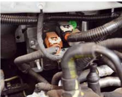
Unidade de controle dos "heaters" do motor EVO VIS
