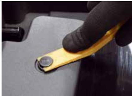
Ao todo, a carenagem principal é fixada por 6 parafusos plásticos e 5 presilhas do mesmo tipo. Sobre o uso dos componentes e grampos plásticos, a Ford esclarece que “estes materiais são testados e validados para esta aplicação e não requerem troca ou substituição periódica. São peças, inclusive, usadas em outros mercados e no Territory comercializado na China”.
