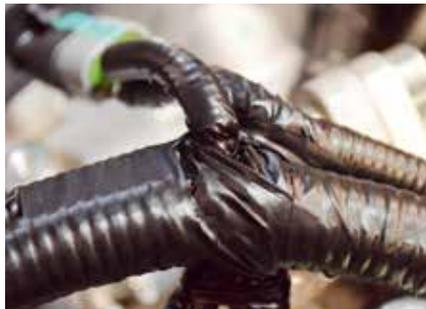
No veículo de teste cedido pela Ford para avaliação antes do lançamento, as emendas das tubulações e chicotes estavam feitas com fita isolante comum (4), o que Mingau estranhou. “Na minha opinião, fitas de tecido seriam melhor opção”, afirmou, apontando que assim haveria melhor reforço e proteção, a fim de evitar calor, atrito ou contato com partes da carroceria. Os chicotes dos sensores do ABS também estavam revestidos com fita isolante comum e o chicote da segunda
