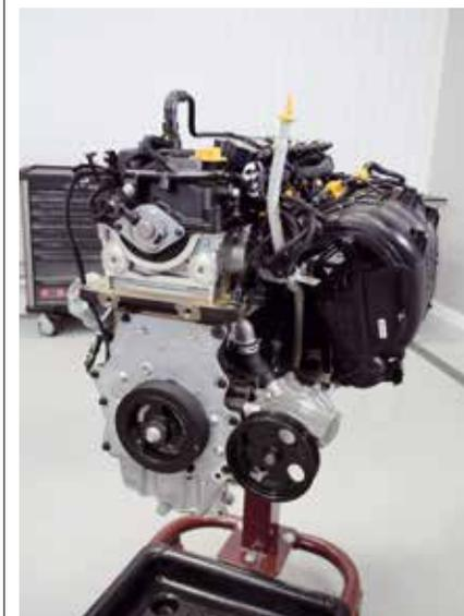
Já a outra modificação é a que dá nome à versão: o sistema VIS ("Variable Intake System", ou "Sistema de Admissão Variável"). Através de um atuador a vácuo (acima) comandado pela unidade de gerenciamento eletrônico da injeção, o sistema VIS altera o fluxo do ar dentro do coletor de admissão acima de 4.250 rpm para permitir maior potência acima dessa rotação. É como se existissem dois coletores, um mais longo, melhor para baixas rotações, e outro mais curto, ideal para altas rotações.
