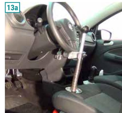
13) A convergência das rodas dianteiras pode ser corrigida nos terminais de direção. Primeiro, instale um dispositivo para travar o volante centralizado (13A). Para quebrar o torque de aperto nos terminais, segure o terminal pelo sextavado com chave 24 mm e solte a contraporca com chave 21 mm (13B). Gire a barra de direção para a esquerda ou direita pelo sextavado com uma chave 13 mm até atingir a medição correta no alinhador, dentro da tolerância.
