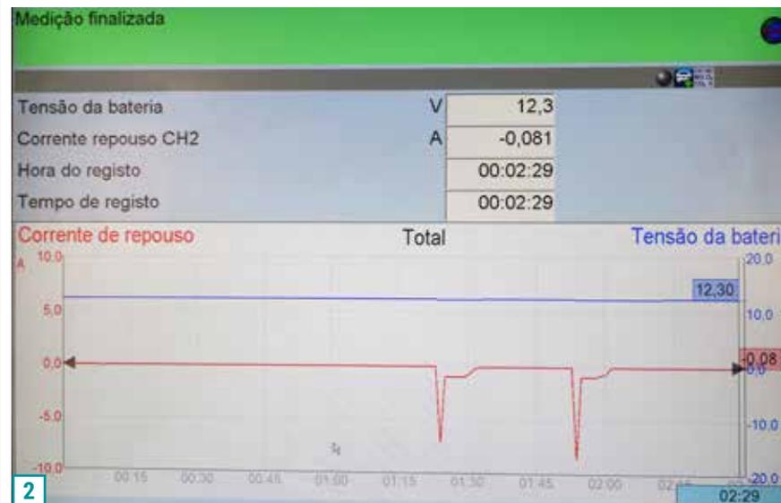
eletrônica embarcada, possuem um processo chamado “power latch”, no qual, após o desligamento do carro, algumas unidades de gerenciamento continuam alimentadas eletricamente por um breve tempo antes de repousarem por completo. Esse consumo não pode ser confundido com fuga de corrente.
