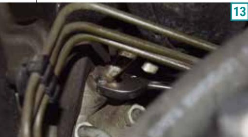
**13)** Com o aparador de fluido posicionado debaixo do carro, faça a soltura dos parafusos das conexões das duas mangueiras hidráulicas da caixa de direção, usando uma chave 17 mm e outra de 19 mm.
