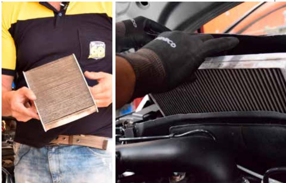
Segundo a fabricante de filtros Tecfil, o filtro de cabine é capaz de conter partículas até 25 vezes menores que um fio de cabelo. “Quando o filtro de cabine fica velho, as partículas de sujeira e bactérias começam a impregnar os dutos de ventilação. Com isso, todo o ambiente interno do veículo é contaminado”, explica o gerente de marketing e novos produtos da Tecfil, Plínio Fazol.
