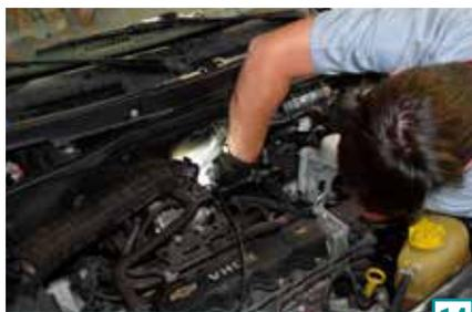
**15)** Retire o parafuso que faz a fixação entre o coxim da carroceria com o suporte que vai ligado à caixa de câmbio. Enquanto um operador tira o parafuso, o outro apoia o coxim para o lado do motorista, para deslocar o parafuso do alojamento. Com o uso de uma chave 18 mm, remova os dois parafusos superiores que prendem o coxim ao câmbio. Não se esqueça de apoiar o câmbio por baixo com cavalete ou suporte apropriado.
