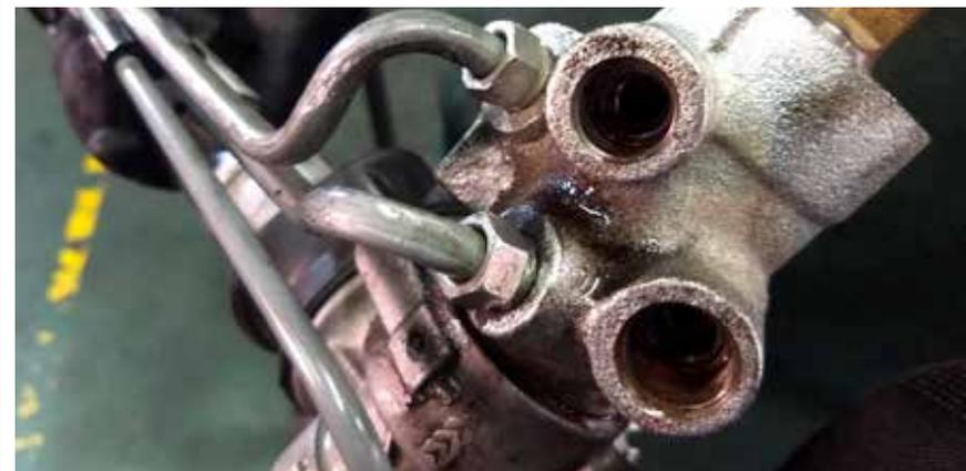
Após a remoção, foi possível ver o vazamento nas conexões na caixa de direção
