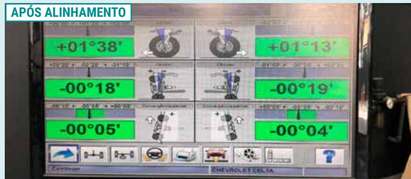
Feita a montagem e os testes dos novos componentes, o etapa final foi o alinhamento. O acerto dos parâmetros de direção permite ao veículo se comportar conforme estabelecido pelo fabricante, além de evitar o desgaste incorreto dos pneus. Mesmo com o "pré-alinhamento" feito durante a montagem dos novos elementos de direção, o equipamento comprovou a necessidade de correção para os valores de fábrica. O alinhamento de direção deve ser feito preventivamente a cada 10 mil
