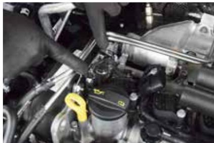
apertado por causa do propulsor 1.4 4-cilindros ser maior que o 1.0 3-cilindros, explica Roberto. Para acessar a bomba d'água, é necessário desmontar o filtro de ar e o coletor de admissão – este, abriga em si o intercooler do ar de admissão, do tipo ar/água.
