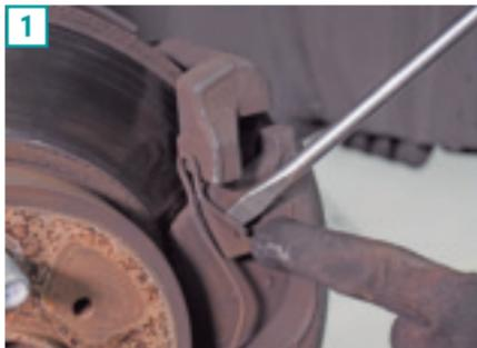
2) Solte a pinça (pinos superior e inferior) com uma chave Allen 7 mm. Com uma chave de fenda, faça a alavanca para soltar a pinça do cavalete.
