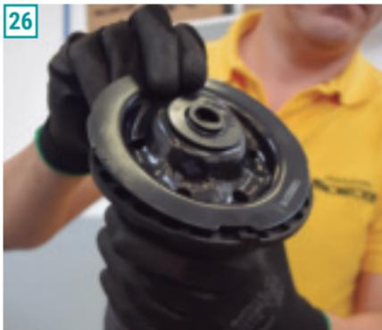
**27)** Por último, coloque o coxim de fixação superior sobre o prato da mola. Note que o novo coxim já traz isolamento de borracha, que deve ser voltado ao prato metálico, e rolamento integrado.
