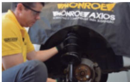
**22** Substituição do conjunto do amortecedor dianteiro do Toyota Corolla GLi
