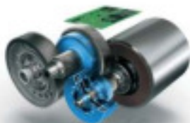
Transmissão de 8 marchas com motor elétrico no interior, o que elimina a necessidade do conversor de torque
