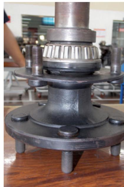
Alguns mecânicos diferenciam as peças chamando-as de “pescoço curto” ou “pescoço longo”, mas é sempre bom deixar o “olhômetro” de lado e medir as peças para evitar erros de aplicação.
