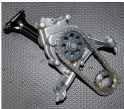
**42)** Bomba de óleo pilotada mecanicamente.
