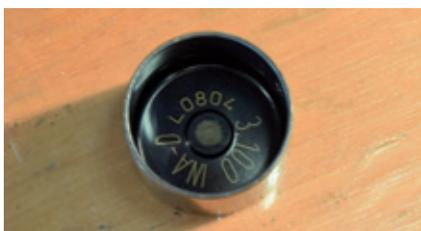
**29)** Tuchos mecânicos, cada um tem uma espessura identificada na peça, assim é necessário fazer a marcação para recolocá-los. Eles regulam as válvulas. O tratamento para a redução de atrito deixa a peça com a cor escura.
