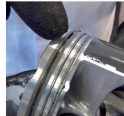
53) Anéis finos com 1 mm de espessura.
