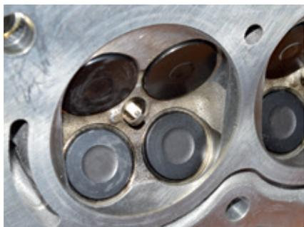
**32)** Válvulas de admissão e escapamento com diâmetros diferentes, eles têm cor escura por causa do tratamento para redução de atrito.
