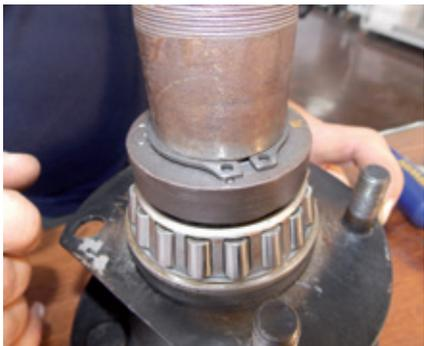
O técnico da Nakata ressalta que o semieixo usado não pode ser reinstalado no veículo se apresentar trincas, deformações, empenamento, se as estrias que engatam na planetária estiverem desgastadas, se a flange apresentar empenamento ou se a pista do rolamento não estiver em bom estado. Caso apresente qualquer um desses sintomas, troque o semieixo por um novo.
