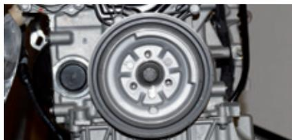
12) Polia damper com amortecimento e massa descentralizada, ela auxilia no equilíbrio dinâmico do conjunto virabrequim para reduzir vibrações. Os parafusos são distribuídos a 120°, um dos furos deve coincidir com o do virabrequim. Atenção para não montar errado, pois, o motor irá trabalhar desbalanceado.
