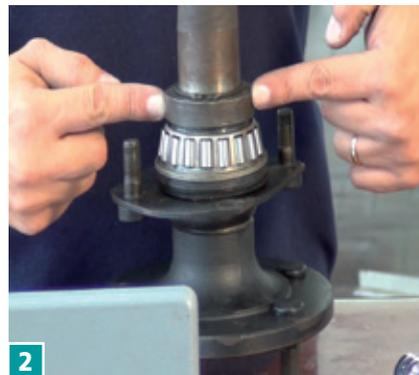
**3)** A preparação da superfície da pista do rolamento e do anel de segurança deve ser feita sem o uso de líquidos gordurosos. Pode ser usado derivados de petróleo, como thinner ou gasolina, ou mesmo água. Após a limpeza, seque o semieixo e instale na prensa, primeiramente, o rolamento, retentor e placa retentora. O anel de segurança deve ser instalado sozinho, depois desse primeiro pacote.
