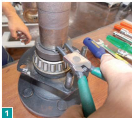
**1)** Para a remoção do anel de segurança, primeiro, remova o anel elástico com o alicate apropriado.
