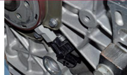
**35)** Sensor de rotação que trabalha com uma polia rodafônica de superfície magnética. Ela é montada entre a flange do virabrequim e o volante. Não deixar cair ou sofrer pancadas, o que pode danificar a parte imantada.
