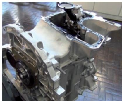
**38)** Cárter dividido em duas partes, uma de ferro e outra de alumínio.
