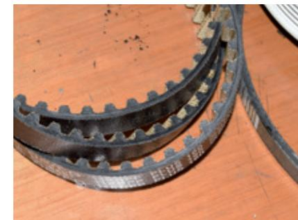
**23)** A correia não possui seta, o recomendado é montar com a indicação do fabricante voltada para parte dianteira do motor.
