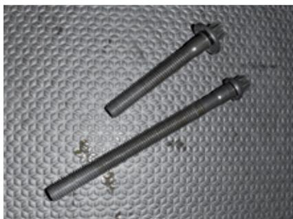
**30)** Parafusos de fixação do cabeçote, os dianteiros são diferentes dos traseiros, as arruelas devem ser removidas após a retirada dos parafusos.
