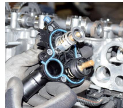
2) Válvula termostática dupla, uma trabalha com a parte superior e a outra, com a inferior do motor.
