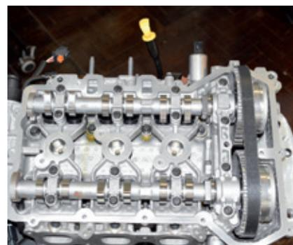
1) Cabeçote em alumínio, na mesma peça está o suporte do motor e a caixa de saída da válvula termostática.
