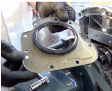
**40)** Retentor de teflon e flange formam uma só peça.
