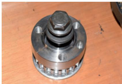
**21)** Cubo que deve ser retirado para remover a correia, sempre que substituir a correia, trocar o retentor do virabrequim.
