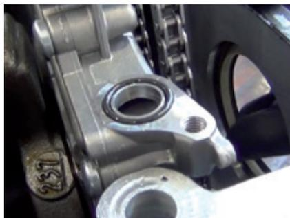
**41)** Ao remover o cárter, substituir o anel de vedação e todas as juntas do motor.
