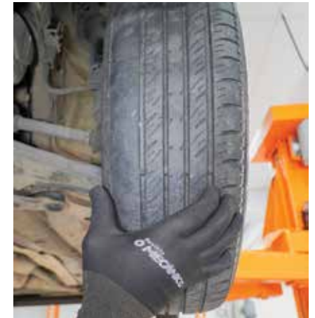
Falta de manutenção na suspensão causou desgaste irregular nos pneus dianteiros: peças gastas e deformadas pelo uso alteram geometria das rodas
