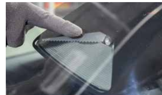
Câmera atrás do retrovisor central que auxilia no sistema Honda Sensing
