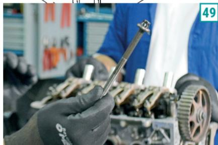
**49)** Os parafusos de cabeçote do motor D4D devem ser obrigatoriamente trocados a cada remoção. Segundo Thiago, é uma constante que qualquer parafuso que receba torque em grau (angular) deva ser substituído porque ele se deforma (estica) no momento do aperto. Um reuso traz risco de quebra do parafuso e consequências graves, desde vazamento de óleo até trinca do cabeçote.
