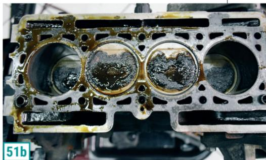
bloco estavam completamente tomadas por óleo, o que, somada à entrada de óleo nos cilindros, denotava a ausência de qualquer vedação dos dutos de lubrificação (51a, 51b).
