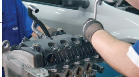
**33)** Solte a tampa de válvulas. São 12 parafusos de cabeça sextavada 10 mm. (A imagem mostra a sequência de **desmontagem**. O lado da exaustão está para cima e o volante, à direita).
