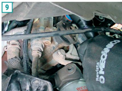
**9)** Quebre o torque dos parafusos frontais de sustentação da bomba da direção. São dois, um acima e outro abaixo do componente.
