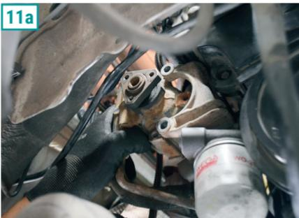
**11)** Retire o parafuso de sustentação traseiro da bomba da direção e, enfim, solte e desloque para o lado a bomba, tomando cuidado para não danificar a tubulação rígida.
