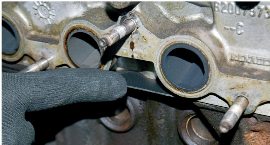
*Motor D4D 1.0 Flex recebeu aplainamento do cabeçote e instalação de junta não-metálica de maior espessura para compensar taxa de compressão: consequências foram desastrosas*
