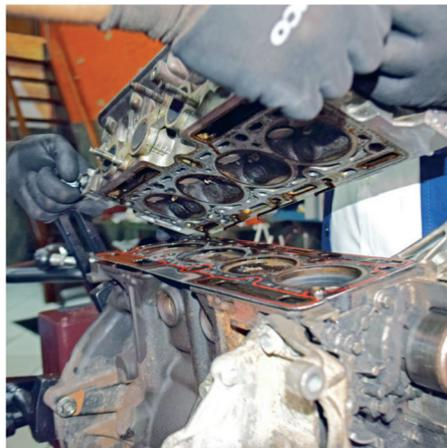
e empenamentos. Tal proibição é feita devido à não utilização de sobrematerial no projeto e fabricação do componente, a fim de reduzir custos e peso”. Insistir na desobediência dessa recomendação, segundo o professor, pode provocar incidentes como: furos em cabeça de pistão (pré-ignição), queima de juntas (empenamentos) e trincas nos cabeçotes.
