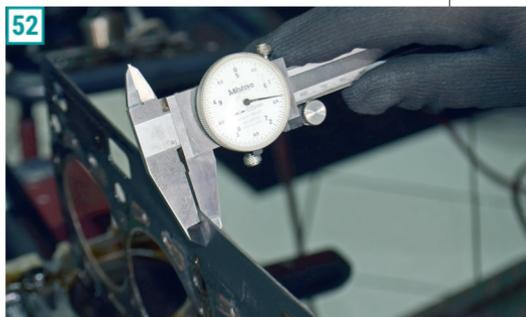
53) Mesmo não aceitando aplainamento, a fabricante do veículo prevê tolerância de altura para o cabeçote:  $99 \text{ mm} \pm 0,05 \text{ mm}$ . Por sua vez, o cabeçote retificado deste motor estava com  $98,86 \text{ mm} - 0,09 \text{ mm}$  abaixo do mínimo. Portanto, o cabeçote estava "morto" e deveria ser substituído.
