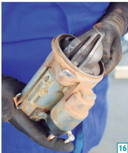
**16)** Neste motor 1.0 3-cilindros, a fixação do motor de partida é feita por um parafuso inferior de cabeça 10 mm e outro superior, de cabeça 13 mm, passante no sentido contrário, que também faz a fixação da caixa seca do câmbio.
