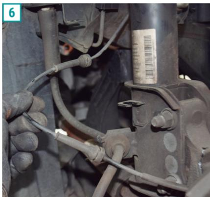
7) Retire os parafusos da manga do eixo, tanto de cima quanto de baixo, com um soquete de 16mm e uma chave soquete Hexalobular E18.
