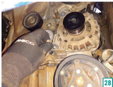
**28)** Solte os parafusos de fixação inferior e superior do alternador.
