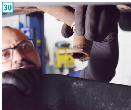
**30)** Solte a mangueira inferior do arrefecimento ligada à bomba d'água e esgote o líquido de arrefecimento.
