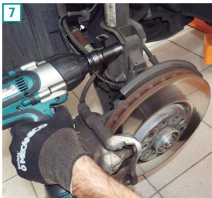
8) Depois de retirar todos os parafusos da manga do eixo, calce-a com um cavalete para retirada do conjunto amortecedor.
