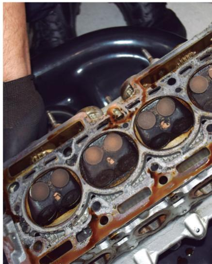
fabricado com “sobremetal” suficiente para ser aplainado (recuperado) e reinstalado.
