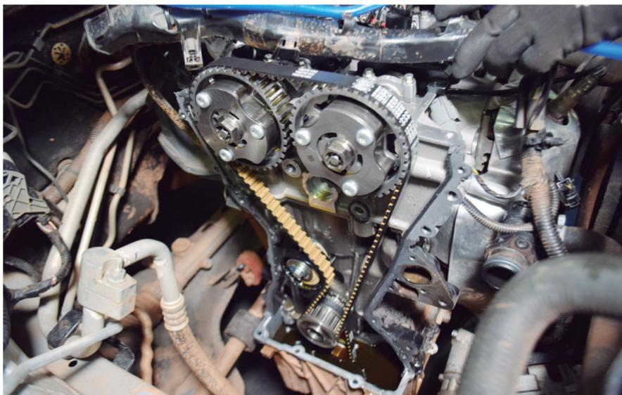
Nos motores 1.0 3-cilindros da Ford, como o do Ford Ka, a recomendação da fabricante do veículo é de substituir a correia a cada 240 mil km, desde que as trocas de óleo sejam feitas utilizando o lubrificante preconizado e nos períodos determinados.
