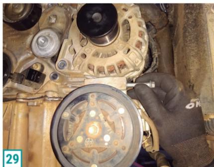
**29)** Em seguida, solte o parafuso de fixação do compressor do ar-condicionado mais próximo de sua polia de acionamento, que está preso à tampa da correia.
