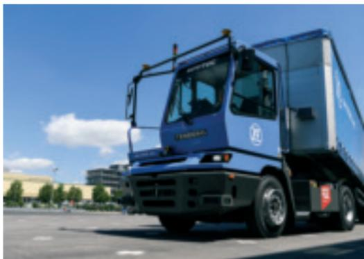
ZF Innovation Truck. Manobra contêineres no terminal de carga e descarga no modo autônomo e elétrico
