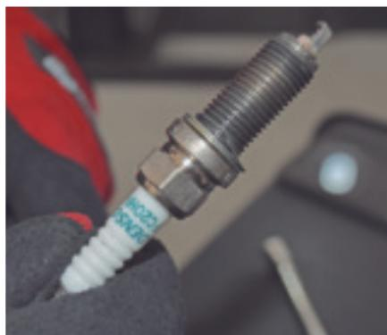
Írídio que, segundo Patrone, devem ser instaladas com o torque correto pelo mecânico na hora da substituição. “A vela de ignição é sextavada de 14 mm e torque baixíssimo. Como a vela de Írídio possui materiais mais nobres, de acordo com o manual, a sua troca é apenas com 100 mil km”, comenta.
