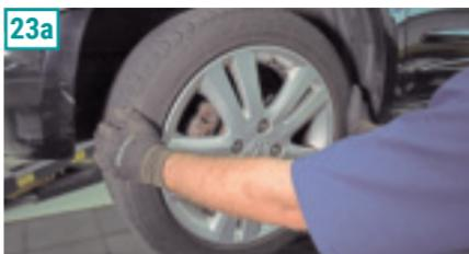
**24)** Gire a roda e segure no corpo do amortecedor para verificar o rolamento. Caso apresente vibração, é sinal de que a peça precisa ser substituída.
