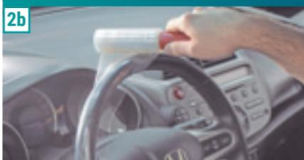
2) Realizada a vistoria, proteja o veículo com capas especiais para este fim: com elas, são minimizados os riscos de um possível dano ao veículo do cliente. Aplique-as nos quatro para-lamas. Na cabine, também é importante a proteção do banco do motorista com uma capa (2a) e do volante (2b) e manopla de câmbio com plástico filme.
