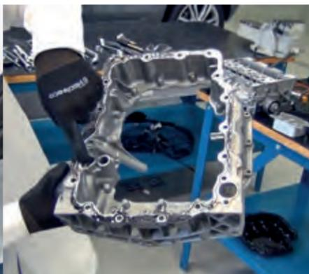
**Obs:** A remoção do virabrequim não é recomendada nem prevista na manutenção deste motor. Devido à diferença de ligas metálicas, caso os mancais (de ferro fundido) sejam soltos, o posterior assentamento das peças com o bloco (de alumínio) não é possível. Por isso, se houver qualquer problema que demande a troca de virabrequim ou mancal, todo o motor parcial deve ser substituído.
