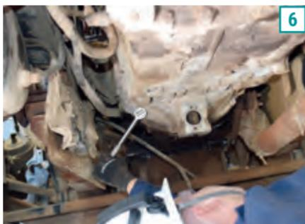
6) Depois de remover o cilindro da embreagem, remova os 6 parafusos de fixação superior da capa seca da embreagem com a ajuda de uma chave torx 55 e um extensor. Neste veículo, não é possível utilizar a pneumática neste passo devido à falta de espaço.
