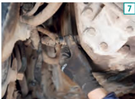
7) Na parte superior da transmissão, remova com as mãos os periféricos e os sensores de ré, sensor de neutro, sensor de reduzida da transmissão, sensor de velocidade e sensor de transferência de caixa.
