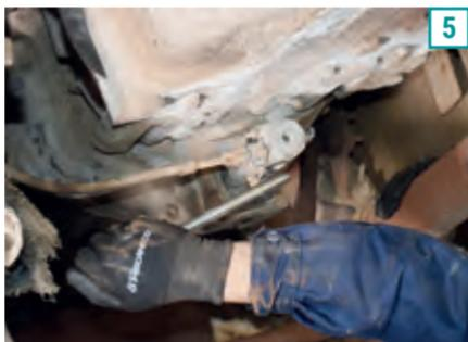
5) Use uma chave 13 mm para retirar a fixação do cilindro de embreagem. Quebre o torque com chave manual e utilize a pneumática para finalizar o processo.
