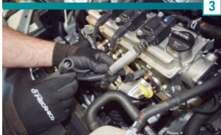
4) Solte os dois parafusos de fixação da bobina com soquete 10 mm. Remova a bobina.
