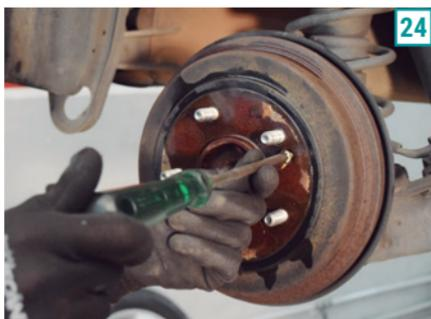
24) Depois de remover as rodas, afrouxe os dois parafusos de fixação do tambor traseiro com uma chave philips. Aplique desengripante para lubrificar e, se necessário, utilize o macete para remover o tambor.
