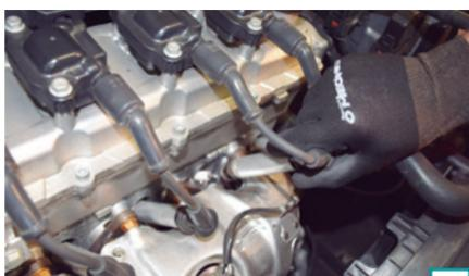
3) Remova o cabo de ignição girando o terminal para descolar da vela e bobina. Sempre puxe-o pelos terminais, nunca pelo fio, pois poderá danificar o cabo. Preste atenção também no sentido de remoção do conector na vela, que deve estar alinhado com o ângulo da vela.
