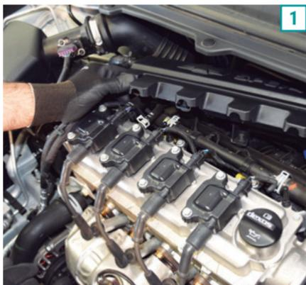
1) Desconecte as fixações da caixa ressonadora para ter acesso aos conectores das bobinas. O elemento serve também como auxílio à ventilação positiva do cárter, possui manguerias conectadas: tome cuidado com suas respectivas conexões.
