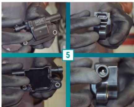
**Obs:** Nesta bobina não há como medir a resistência, afinal, possui o módulo acoplado a si. Na verdade, ao colocar as pontas de prova nos contatos do conector de entrada, o multímetro vai medir a resistência do circuito de comando, e não o primário da bobina.
