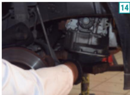
**14)** Utilize um cavalete sob o cárter do motor do veículo, a fim de calçá-lo e permitir a retirada do coxim direito do motor.
