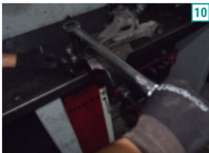
**10)** Faça a fixação do pivô com chave 17 mm. Torque de aperto nas porcas é de 30 Nm.
