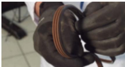
**Obs:** A correia do alternador, visualmente, não apresentava avarias, no entanto, a que comanda o ar-condicionado apresentava ressecamento, desgaste e contaminação por óleo.
