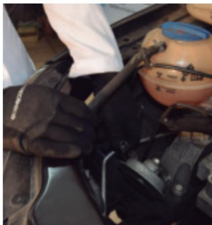
**Obs. 1:** A buzina é fixada a este suporte, mas não é necessária à sua remoção de maneira prévia. Esta deverá sair juntamente com o suporte do coxim, tendo seu conector desligado, apenas.
