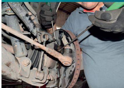
8) Enfim, puxe a fiação do sensor e afaste-a para não ter risco de ser danificada no restante do procedimento.
