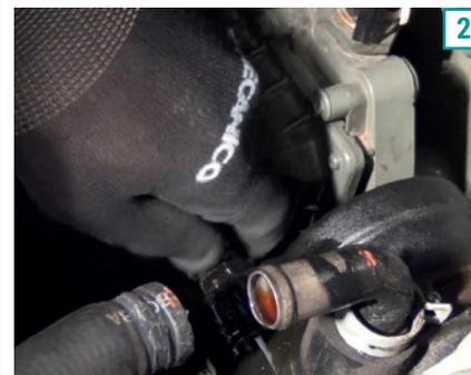
3) Retire os dois parafusos de fixação da bomba hidráulica no compressor de ar utilizando chave allen 8 mm.
