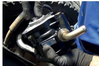
**44** Troca da bomba hidráulica no caminhão VW 8-150
