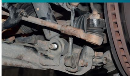
11) A remoção da bandeja superior demanda a soltura dos parafusos de fixação do pivô. Primeiro, faça apenas a quebra do torque de fixação dos quatro parafusos, em cruz, com soquete 12 mm.
