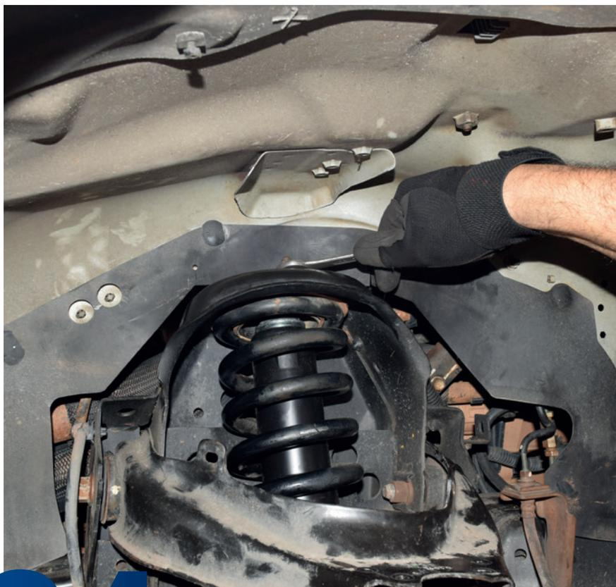
**34** Confira o procedimento de substituição dos amortecedores dianteiro e traseiro em uma picape Chevrolet S10 LT 4x4
