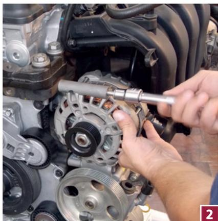
**Obs:** No veículo, será necessário também soltar as mangueiras do circuito da direção hidráulica ligados à bomba, além do conector do chicote. Não se esqueça de colocar uma bandeja ou aparato para conter a queda de fluidos no chão.
