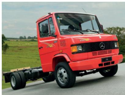
Fabricado entre 1972 e 2012, com uma breve parada em 1998, o "Mercedinho", como ficou conhecido, foi o primeiro caminhão na categoria dos leves da Mercedes-Benz. Suas versões são a 608D, 710E e a 712, que variam de acordo com a data de fabricação, capacidade de carga e capacidade do motor. Existe ainda outras versões de maior motor e capacidade de carga, da qual o modelo foi base.
