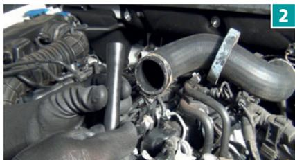
**2** Antes de remover a mangueira inferior de arrefecimento, providencie um tampão para conter o vazamento do líquido de arrefecimento.
