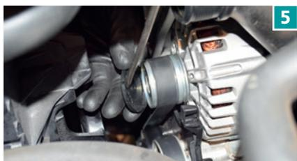
**5** Retire a tampa de proteção da polia do alternador, também com chave de fenda.
