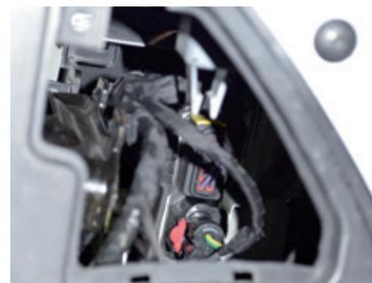
**33)** IHCU – Central de controle do sistema de partida a frio com dois conectores, localizada no lado esquerdo atrás do para-choque dianteiro.
