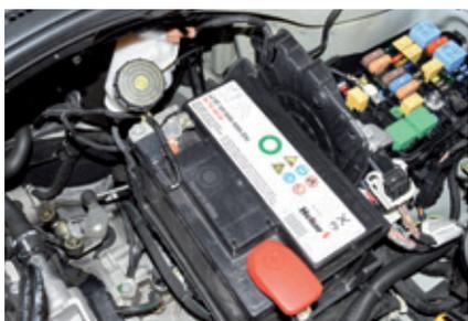
**29)** Bateria. Sempre obedecer a especificação correta da fabricante do veículo ao substituí-la, pois, uma bateria errada compromete todo o sistema elétrico do veículo.
