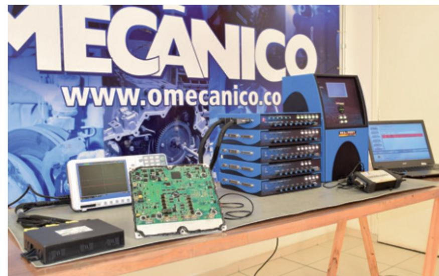
Visando essa necessidade, a empresa Chiptronic desenvolveu para o setor de manutenção de veículos comerciais uma bancada completa de testes para diagnóstico e manutenção de ECUs. "É um reparo complexo, por isso, é muito importante que você tenha os equipamentos corretos e as informações necessárias para conseguir dar sequência em um trabalho como esse – que é complexo, mas muito rentável", declara Luciano Vaz, da área de treinamentos da Chiptronic.
