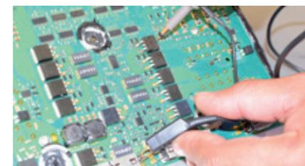
O procedimento a seguir foi executado em um módulo Scania Euro V que, conforme reclamação do cliente, apresentava defeito no acionamento da unidade injetora de combustível nº5.
