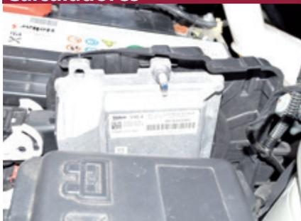
**27)** Módulo de injeção eletrônica fornecido pela Valeo (modelo AV46) com três conectores.
