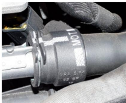
**8)** Sensor de temperatura do líquido de arrefecimento.
