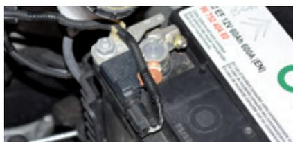
**30)** Calculador localizado no polo negativo da bateria (caixa de carga da bateria). Faz a gestão do que entra e sai de carga, trabalha diretamente com o outro calculador que é o alternador. Recomenda-se, ao utilizar carga auxiliar, que o conector deve ser colocado na chapa e não direto no polo, pois pode queimar o calculador.
