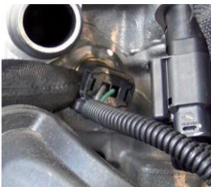
**11)** Sensor de temperatura do líquido de arrefecimento.
