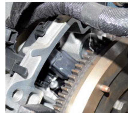
**16)** Sensor de rotação do motor.
