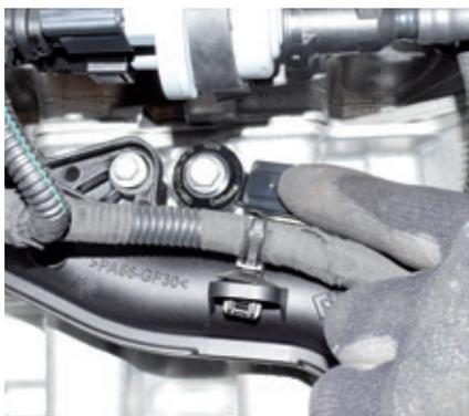
**9)** Sensor de detonação colocado na parte traseira do motor.
