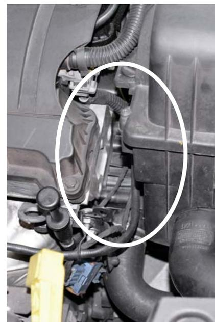
A localização da válvula neste motor facilita a manutenção: basta remover o filtro de ar para ter acesso visual ao componente. Entretanto, existem alguns pontos aos quais o mecânico precisa prestar atenção.
