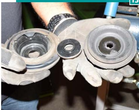
14) Observe que prato de mola possui calço antirruído embutido. "Um sistema simples e robusto", comentou Alexandre. Removendo a mola, observa-se outras duas características para atenuar o ruído: o revestimento de borracha no elo inferior (14a) e o calço de borracha no prato inferior do amortecedor, preso por três guias (14b).
